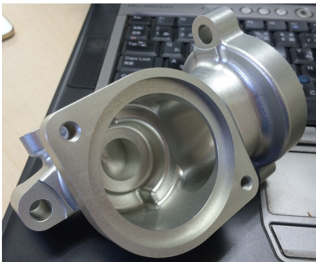
高精度複雑形状の5軸削り出し部品
